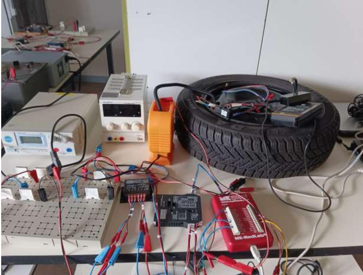
Sagatavošanās mācību procesam priekšmetā “Sistēmas ar elektronisku vadību”. Laboratorijas darba «Vienmērīgu apgriezienu uzturēšana elektromotoram ar elektronisku vadību» praktiskās daļas aprīkojums.
