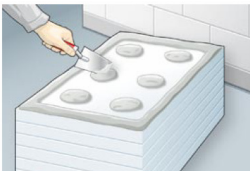
7 att. Līmjavas uzklāšana uz siltumizolācijas loksņēm, gadījumos ja virsma nav ideāli līdzena [1]
