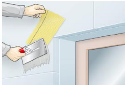
24 att. Papildus stūru armēšana ar stikla šķiedras sieta elementiem [1]
