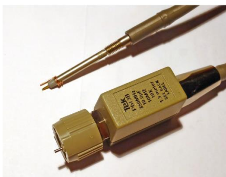
4.3. attēls Oscilogrammu uzņemšanai izmantotā tausta konfigurācija
